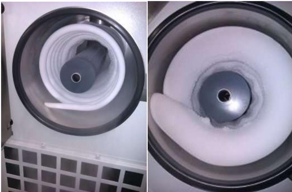
Le coût de fonctionnement du lyophilisateur pilote compact se limite à sa consommation électrique. Sa puissance absorbée est inférieure à 4000W lors du refroidissement initial et inférieure à 2000W ensuite ce qui présente un coût dérisoire en regard de la valorisation du produit lyophilisé.
